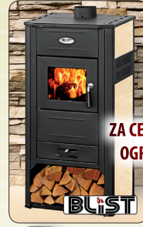
PEČ BLIST AMBASADOR "E", s priklopom na centralno ogrevanje Dimenzije: 490 x 460 x 1050 mm; moč: 20-22 KW; moč za ogrevanje vode: 15-17 KW; velikost kotla: 22 l; teža: 98 kg.
